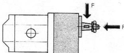
Das Zwischenlager ist kein Standardlager für alle Einsatzbedingungen. Es wurde speziell für niedrige Leistungen, z. B. für den hydraulischen Lüfterantrieb von Verbrennungsmotoren, projektiert. Das Leichtmetallgehäuse des Zwischenlagers ist mit einer Kuppelungswelle und zwei Wälzlagern ausgerüstet. Ein antriebsseitig eingesetzter Wellendichtring und eine pumpenseitig zwischengelegte Flachdichtung gewährleisten einen wartungsfreien Betrieb der fettgeschmierten Lager.
